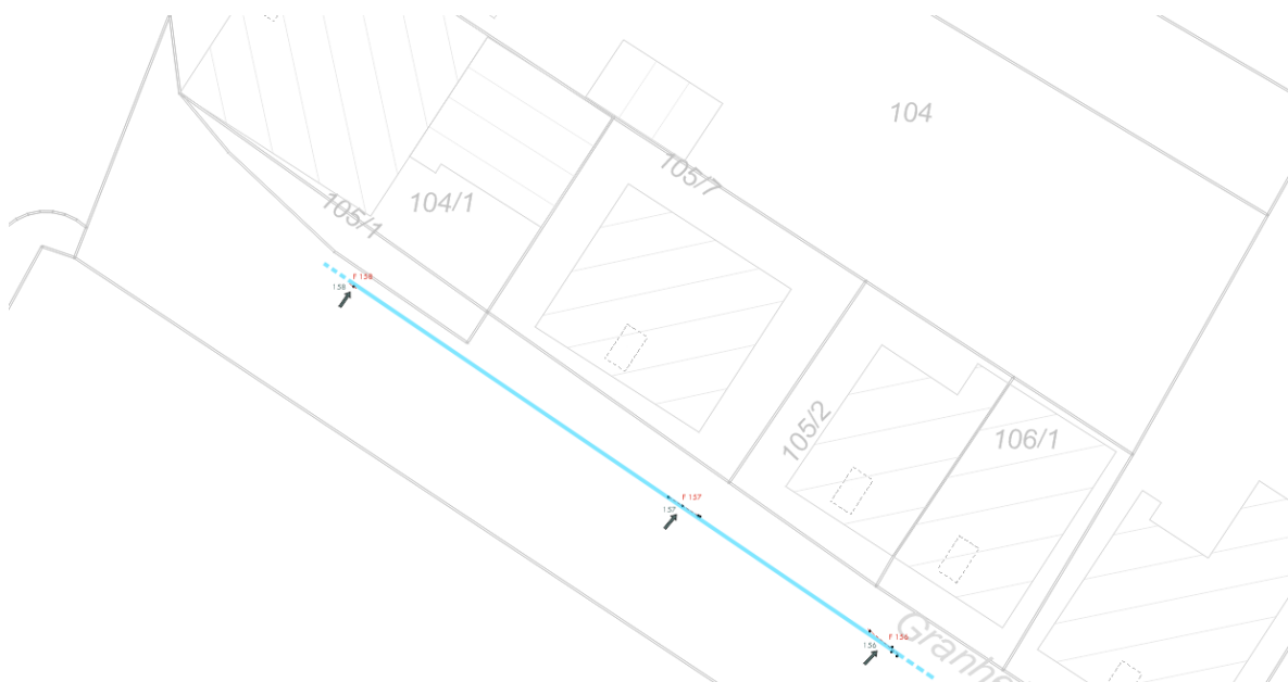
Abb. 14 Dokumentierter Verlauf der Deichelleitung in der Granheimer Straße
